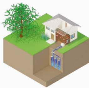
Pompe à chaleur sur corbeilles géothermiques
